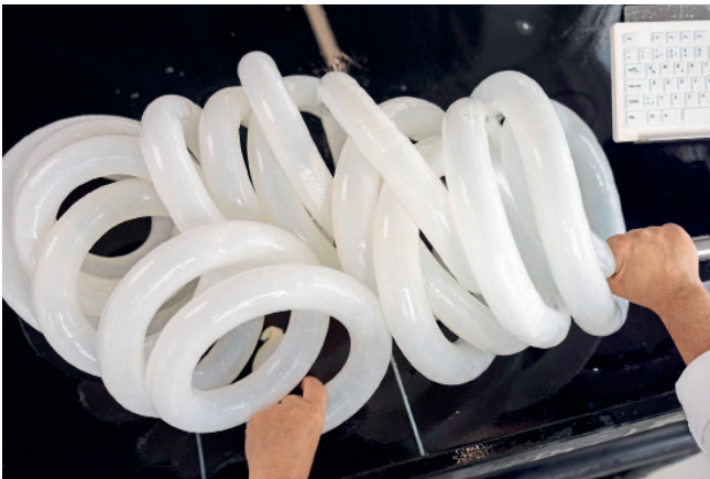
Rinderdärme werden mit Luft gefüllt, um die Ware auf Kaliber, Länge, Lochfreiheit und Farbe zu prüfen. Zentralverband Naturdarm/rotoshot.de
