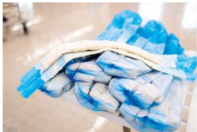
Soft-Tubes sind flexibel und faltbar, sie lassen sich in hoher Stückzahl im Fass transportieren.
