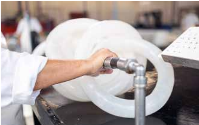
„Kontrolle“: Naturdärme werden unter Druck mit Luft gefüllt, um eine einwandfreie Qualität sicherzustellen.
